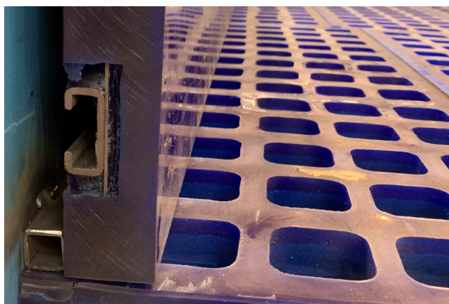
Využití montážních C profilů pro třídiče sypkých materiálů
