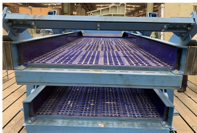
Využití montážních C profilů pro třídiče sypkých materiálů
