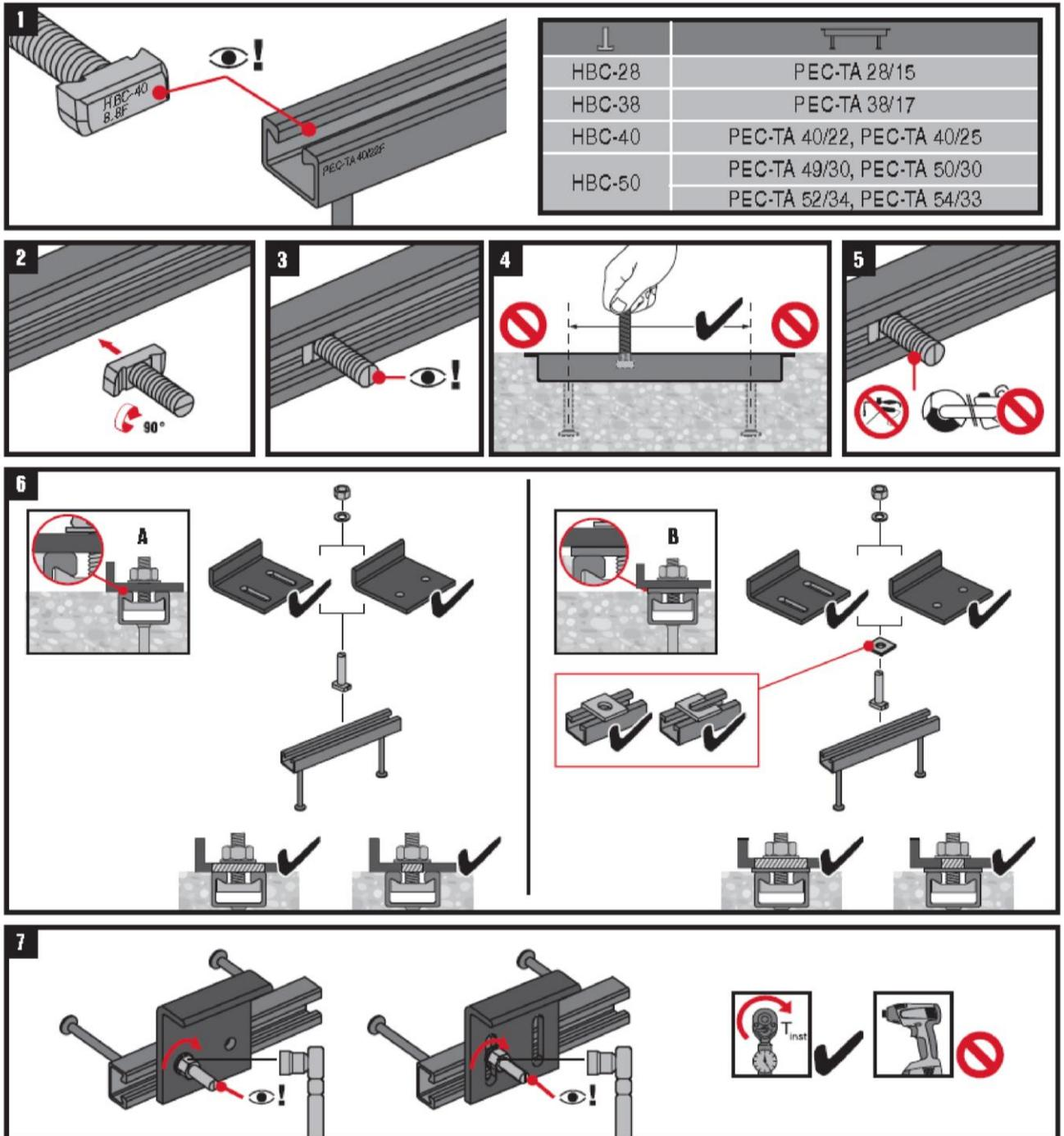
$T_{inst}$  ist das Montagedrehmoment, das mit einem Drehmomentschlüssel aufgebracht wird und nicht überschritten werden darf
