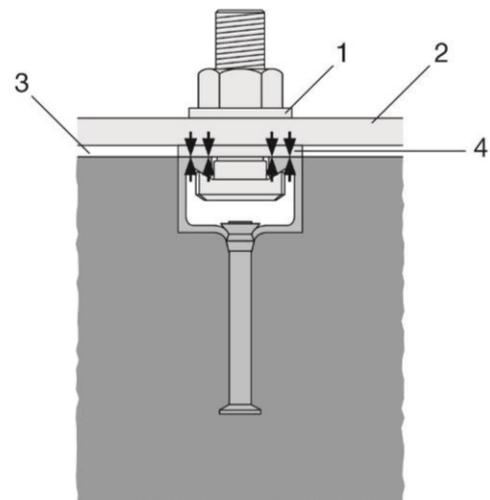
Ankerschienen (PEC-TA) mit Spezierschrauben (HBC)
