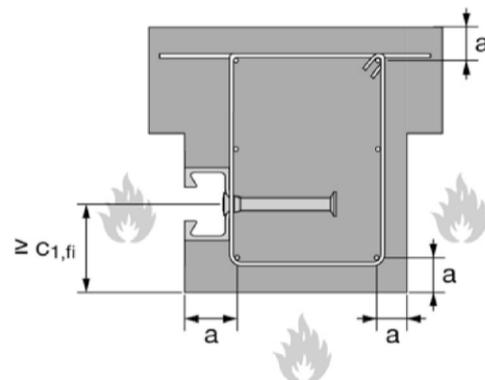
**Ankerschienen (PEC-TA) mit Spezialschrauben (HBC)**
